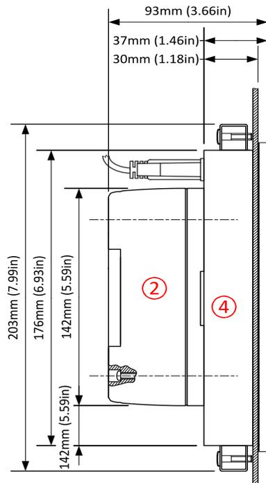
**Hinweis:** IntelSysNTC BaseBox kann an einer Standard-Hutschiene oder, zusammen mit InteliVision 5 oder InteliVision 8, in einer Schaltschranktür montiert werden. InteliVision 5 verfügt über eine Befestigungsschiene für direkte Montage. Die Montage zusammen mit InteliVision 8 erfordert vier Schrauben, die im IntelSysNTC BaseBox Lieferumfang enthalten sind.
