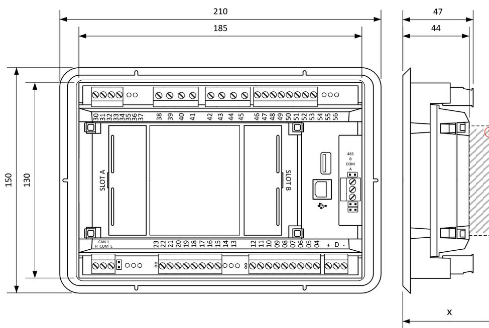
**Nota:** La profundidad final del controlador depende del modulo de extensión instalado – puede variar entre 41 mm y 56 mm. Tomar en consideración el tamaño de los conectores y cables (P.ej. En caso de conectores RS232, añadir unos 60 mm para conectores y cables standard).
